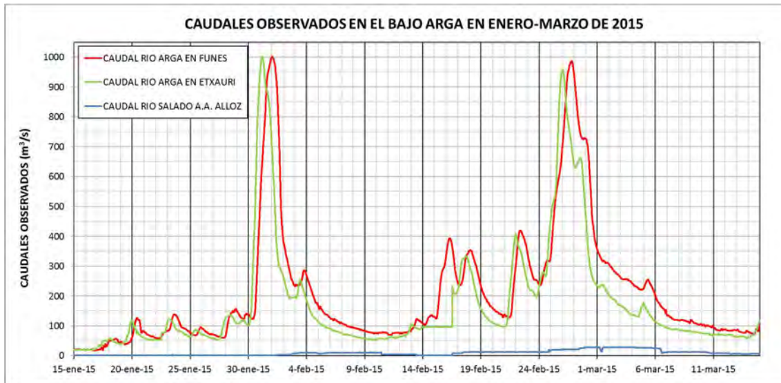
Ilustración 47. Caudales observados en las estaciones de aforo de Etxauri, Funes y el río Salado A.A. de Alloz, durante dos eventos de gran magnitud que ocurrieron en el periodo de enero-marzo de 2015 en la cuenca del Arga. Se trata en concreto de los eventos 9 y 10 mostrados en la Tabla 7 .
